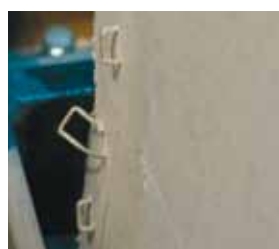
Test Shake Table (zatížení) - Vytažené spony po ukončení namáhání. Namáhání při zemětřesení Petrovac / 1979 N-S (Černá Hora)
